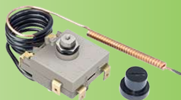
Limiteur bipolaire à réarmement manuel avec sécurité positive, plages jusqu'à 170°C, température fixe
